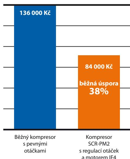
Kompresory SCR-PM2 dokáží energetické náklady snížit extrémním způsobem. Běžně dosažená úspora se pohybuje na úrovni 38%, v některých případech však dosahuje až 50%. Základem pro takovou redukci jsou eliminace chodu naprázdno díky plynulé regulaci otáček, bezeztrátový převod 1:1, vysoká účinnost šroubového bloku a použití nejmodernějších motorů s permanentními magnety s účinností IE4.
