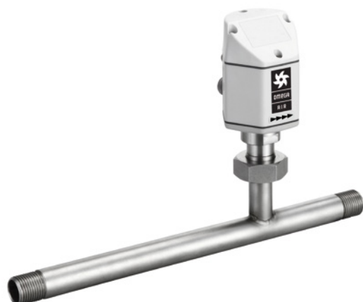
OS 420: zkrácená vstupní sekce! doporučená délka vstupní sekce je: L = 15 \times \text{průměr vstupního potrubí}
