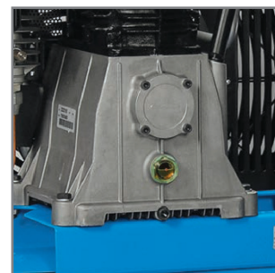
Olejoznak umožňuje snadnou kontrolu stavu oleje.
