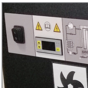
Elektronická jednotka pro řízení chodu a signalizaci poruch.
