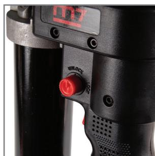
Tlačítko LOCK - UNLOCK pro uzamčení spouštění před nechtěným zapnutím nářadí.
