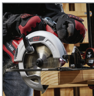
Možnost nastavení úhlu řezu v rozmezí 0 až 56°.
