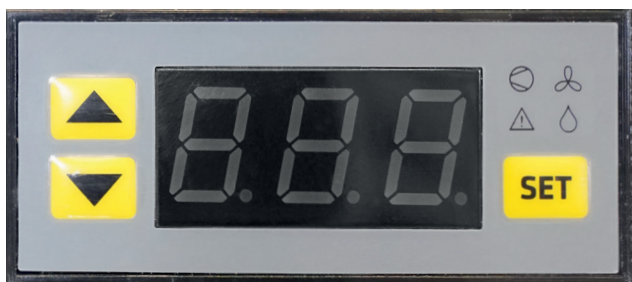
Elektronická řídicí jednotka pro ovládání chodu a signalizaci provozu a alarmů
